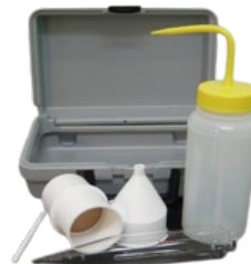
Sieb-/Messzylinder und Spritzflasche im Transportkoffer
